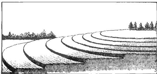
FIG. 178.—Level-bench terrace. (Bul. 236, North Carolina Station.) (F. R. Baker.)
