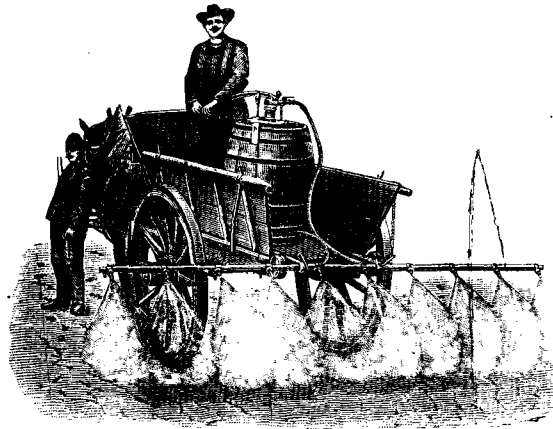
Fig. 153. Fortschritt-Spritze mit zehn Verstäubern in Betrieb. (Carl Platz, Ludwigshafen a. Rh.)
